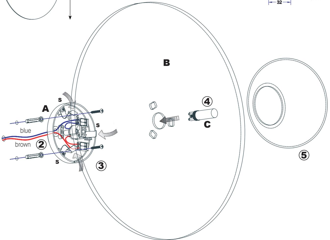
**3 Colocar la pantalla ( B ), encarando sus tres agujeros rectangulares con los muelles fijados en la base (A). Presionar ligeramente la pantalla (B), hasta que los muelles queden fijados en la misma, sobresaliendo parte de los mismos.**
