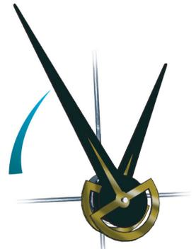
Girar cuidadosamente la aguja minuterá en el sentido de las agujas del reloj hasta alcanzar las 12 en punto, ajustar la hora alineando las agujas horaria y minuterá en vertical, luego continuar girando la aguja minuterá hasta alcanzar la hora deseada. **ATENCIÓN: Nunca girar en sentido contrario a las agujas del reloj.**
